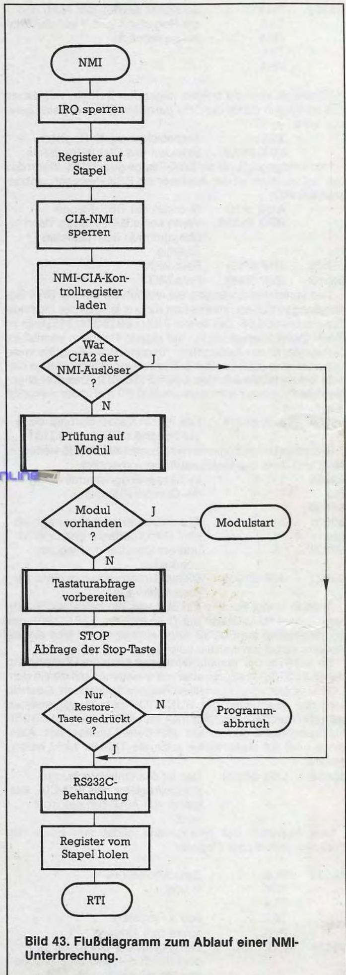
Bild 43. Flußdiagramm zum Ablauf einer NMI-Unterbrechung.
